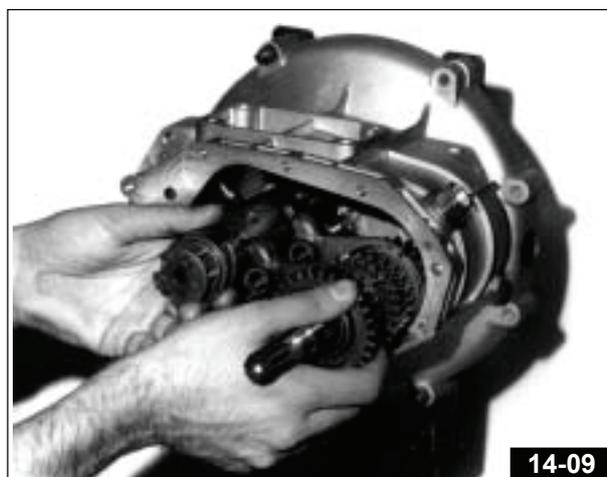
Dévissez l'écrou de fixation du corps interne d'embrayage à l'aide des clés appropriées «**A**» - **Fig. 14-10** code 30 91 28 10 et «**B**» - **Fig. 14-10** code 14 91 26 03 et extrayez le corps interne d'embrayage au moyen d'un extracteur universel au besoin.
