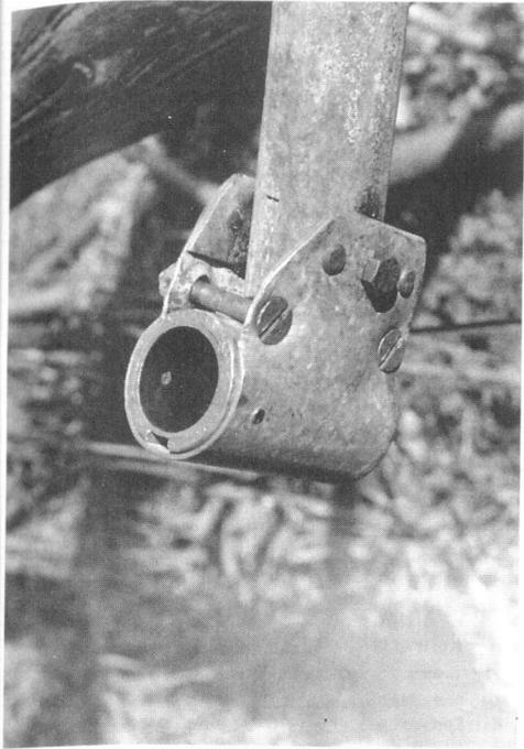
Ohne Schweißen gebaute Ein-Spur-Hängerkupplung
