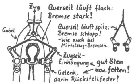
Querseil läuft flach: Bremse stark!
