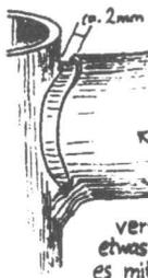
Bei Rohr unter 2 mm Wandstärke Einlegerohr verwenden. Beim Schweißen etwas vorstehen lassen, damit es mit verschweißt wird.
