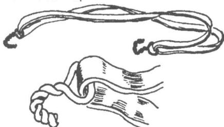
Packriemen aus altem Fahrrad-schlauch und aus Zaundraht gebogenen Haken. Aut Schlauch in Streifen geschnitten geht auch.
