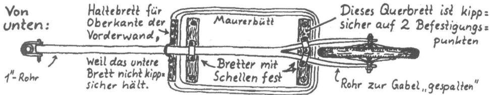
Für die einfachste Bauart (wiegt ca 9 kg, trägt über 50 kg) nimm ein 1"-Wasserrohr (verzinkt rostet nicht), laß die Winkelbiegung beim Klempner im Rohrbieger kalt biegen (Rohr nicht weichglühen!) und biege die weiten Bögen von Deichsel und Gabel selbst zB unter einem Müllcontainer (s. Photo). Von 1"-Heizungsrohr (unverzinkt) liegen im Schrott oft Stücke mit schon passender Winkelbiegung!
