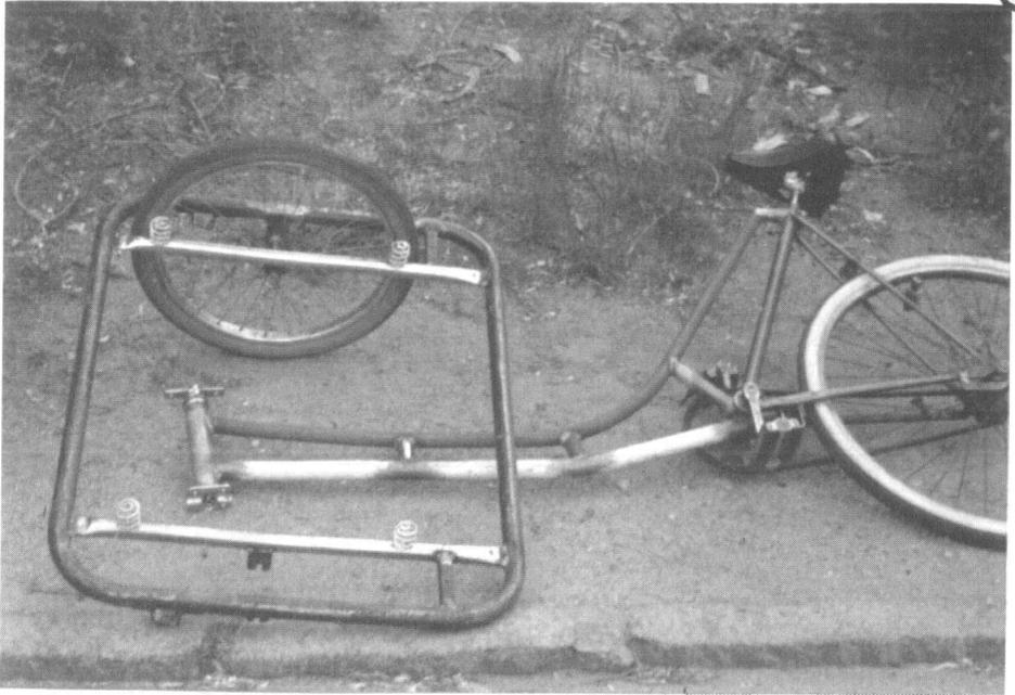
Vorderradrahmen mit Federung, Rahmen mit Lenkungslager, darin BMX-Rad-Lenkerschaft, der werksmäßig Platte mit Schraubenlöchern hat.
