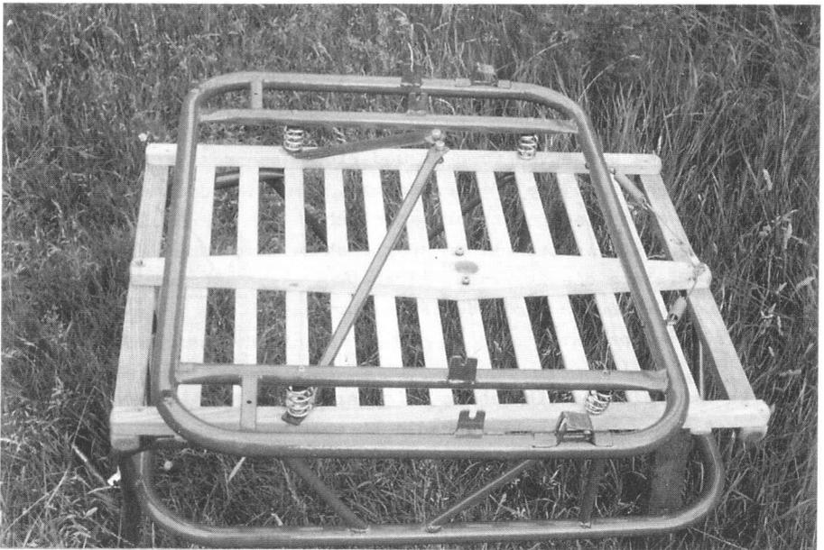
„Fahrgestell“ an 4 Spiralen unter die Ladefläche (Lattenrost) geschraubt. „Stabilisator“ nur vorn →, von den Streben zum Lenklager sind erst die nach schräg hinten angebaut.
