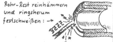
Fürs Kupplungsstück baue ein Rohr genau passend zur Sattelstütze (vgl. S. 44), biege ein Flacheisen (mind. 5x25 mm stark) drumherum und schweiß es an:
