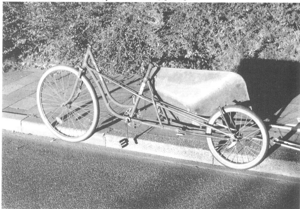
Rahmen verstärkt, Hinterradstreben B gekürzt, Streben C am Sattelrohr.
