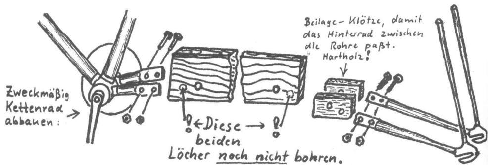
Achtung ! Nicht gleich bohren. Erst mit je einer Schraube provisorisch zusammenschrauben, 20"-Hinterrad einsetzen, Brett unterstützen, Tretlager unterstützen, durch die Höhe der Unterstützungen das ganze Gebilde ausrichten :
