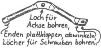
Zur Radmontage Zusatzrohr am Rahmen lockern und seitlich schwenken. Von oben:
