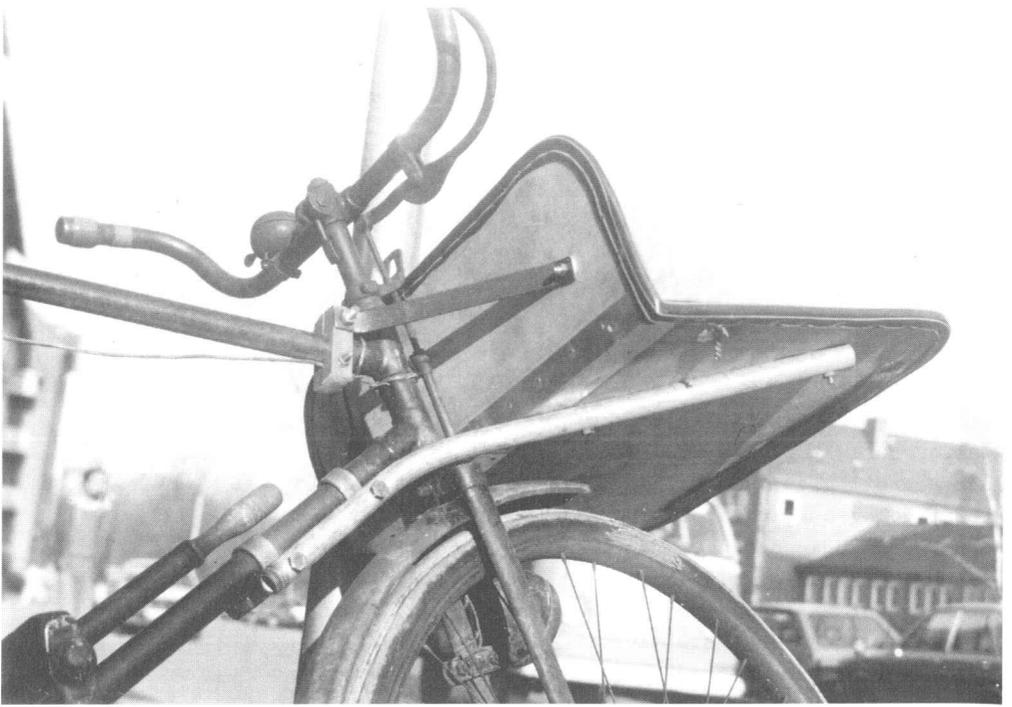
①⑥ Der Lastenträger von unten ↗ Detail: Befestigung am Rahmen ↘
