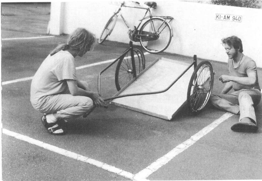
Rollstuhlrädern und Sperrholzkasten. Die Seitenwände fehlen noch.
