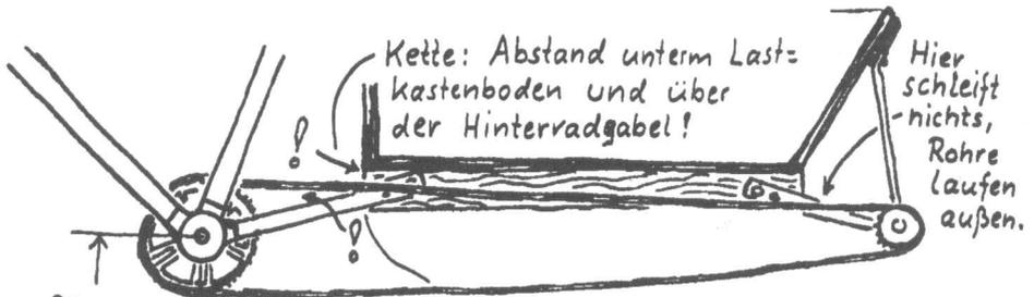
30 cm über der Fahrbahn 'Notfalls Hinterradgabel höher biegen?'
