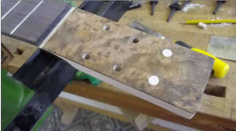
Le repérage des trous doit être soigneux surtout si d'autres trous ont déjà été percés. On veillera à ne pas répéter les erreurs ayant nécessité la réparation.
